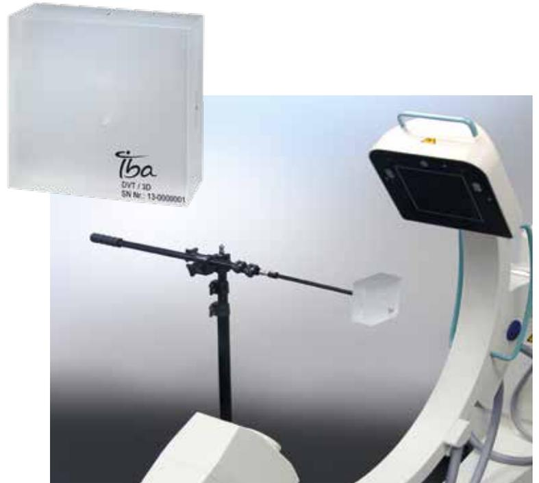
Einzigartige Stativlösung zur einfachen Positionierung des Phantoms.
